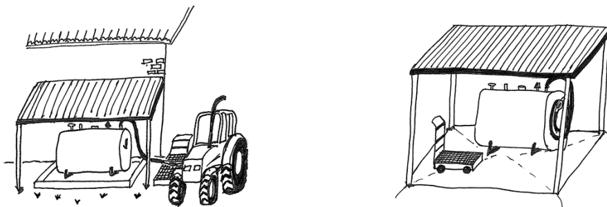
Eksempler på påfyldningsplads med mobil spildbakke
